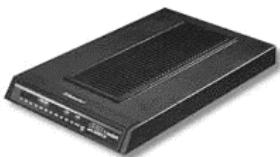
إن المودم عبارة عن جهاز يستخدم في توصيل الحاسوب الذي تعمل عليه بنظام الهاتف. ويقوم المودم بتحويل البيانات إلى صوت يتم إرساله عبر خط الهاتف ويقوم المودم المستقبل بتحويل الصوت إلى بيانات. وإذا رغبت في الاتصال بالإنترنت، ستحتاج إلى مودم.
