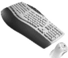
ما زالت لوحة المفاتيح هي أكثر وحدات إدخال البيانات إلى الحاسوب شيوعاً واستخداماً. وهناك أنواع مختلفة من لوحة المفاتيح، بما في ذلك تلك المصممة خصيصاً للاستخدام مع نظام تشغيل مايكروسوفت ويندوز.
