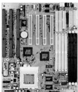
توجد اللوحة الأم (لوحة النظام) داخل وحدة النظام ويتم توصيل كل مكونات الحاسوب الأساسية بشكل مباشر بها. وتوجد وحدة المعالجة المركزية في لوحة النظام إلى جانب المكونات الإلكترونية الأخرى. ويتم توصيل مكونات أخرى مثل القرص الصلب بهذه اللوحة بشكل مباشر أو من خلال كابلات. إن هذه اللوحات يقل حجمها يوماً بعد يوم لأن المكونات تصبح أكثر دمجاً. فإذا قمت بفتح أية وحدة حاسوب حديثة، فلن تجد غير مكونات صغيرة جداً.
