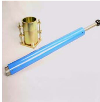
شكل (١٠,٣) جهاز الدمك وجهاز الاختراق المستخدمان في اختبار التحميل النسبي.
