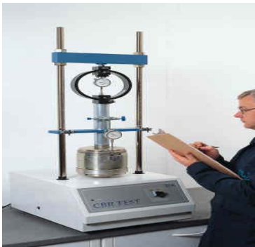
شكل (١٠,٣) جهاز الدمك وجهاز الاختراق المستخدمان في اختبار التحميل النسبي.
