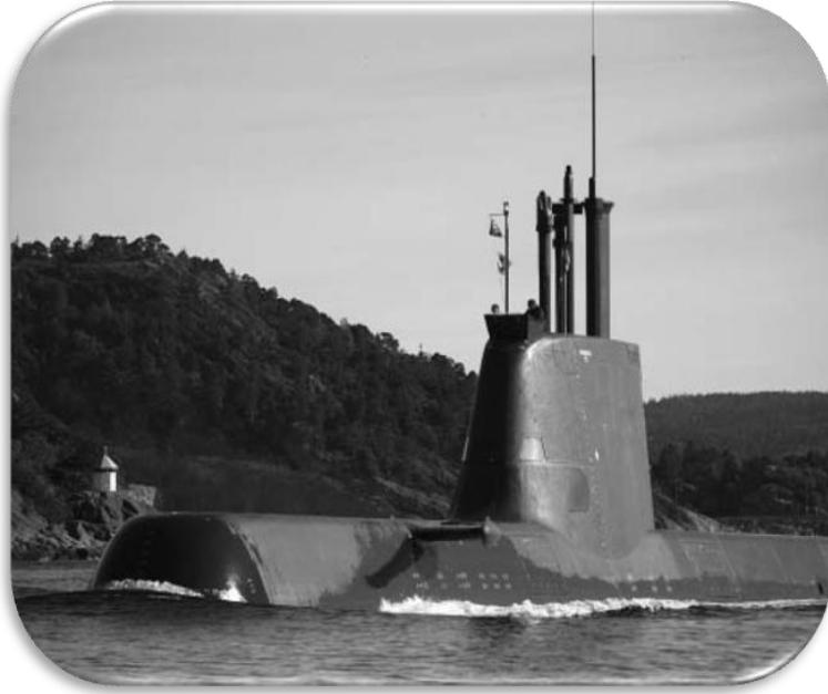
شكل ( ٣ ) صورة تظهر فيها الزعنفة وقد ارتفعت منها صواري اجهزة المراقبة والاتصال وغيرها وقد خرج منها بعض البحارة
