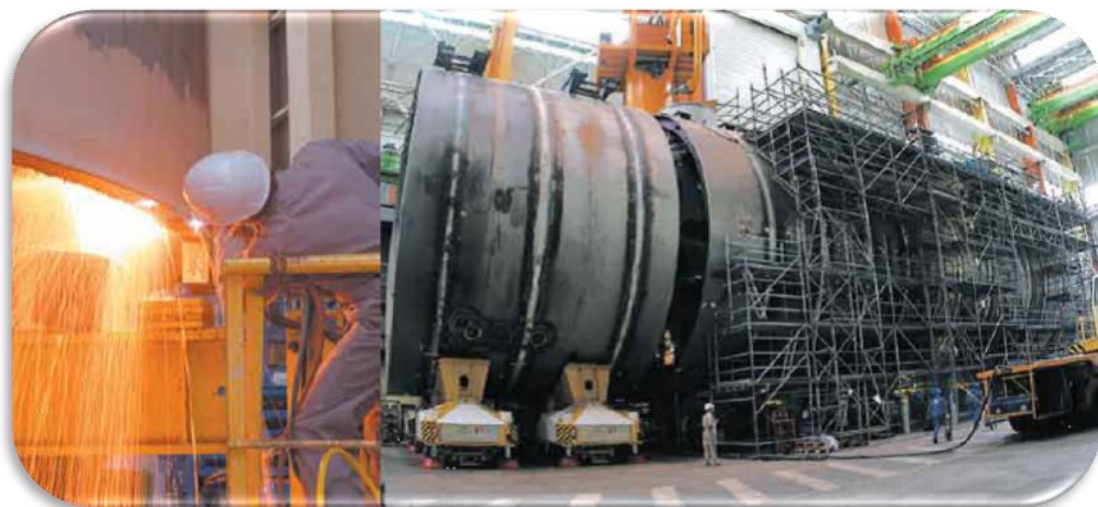
شكل (٣١) صورة تبين ورشة عمل الغواصة الفرنسية سكوربيون وعملية تصنيع الهيكل باللحام
