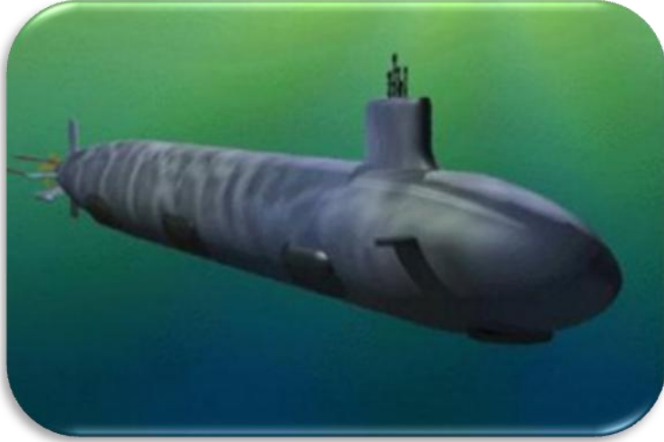
شكل (1) صورة تظهر الشكل الاسطواني للغواصة مع النهايات المستدقة والزعنفة ) الغواصة فيرجينيا ٧٧٤ (SSN)
