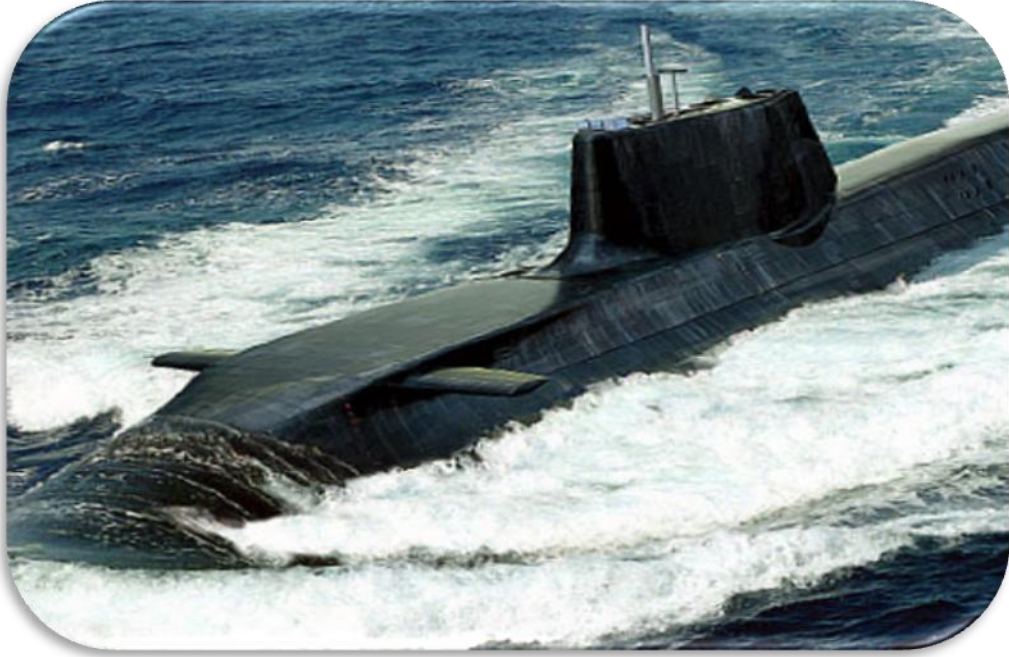
شكل ( ٦ ) الغواصة البريطانية الحديثة UK's HMS Astute حيث تظهر في الصورة اجنحة المقدمة
