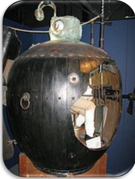
شكل (٣٣) صورة لنموذج يمثل الغواصة الأولى حيث كانت تدار وتدفع بالقوة البشرية
