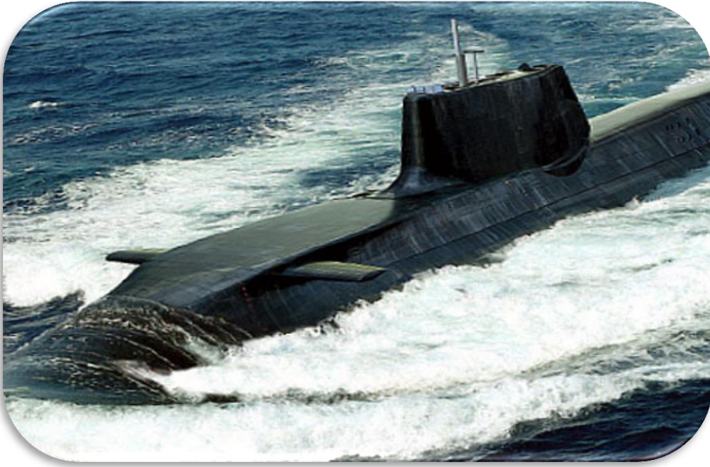
شكل ( ٦ ) الغواصة البريطانية الحديثة UK's HMS Astute حيث تظهر في الصورة أجنحة المقدمة
