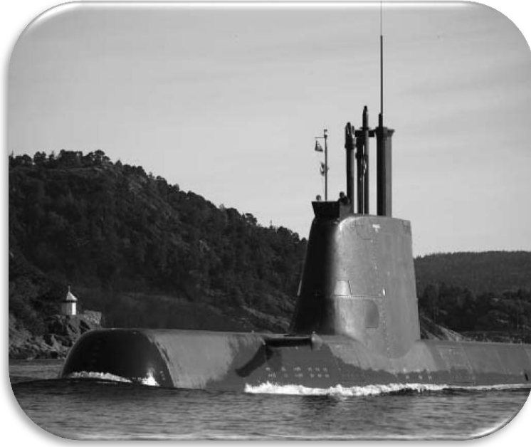
شكل ( ٣ ) صورة يظهر فيها البرج وقد ارتفعت منه صواري أجهزة المراقبة والاتصال وغيرها وقد خرج منه بعض البحارة
