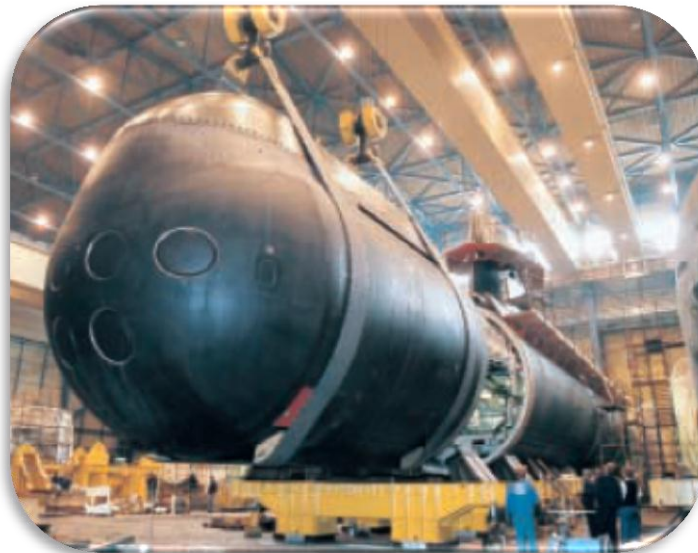
شكل (٣٣) الغواصة السويدية جوتلاند اثناء التجميع
