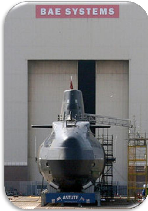
شكل (٢٩) الغواصة الحديثة HMS Astute مثال عن تصميم "الدمعة".
