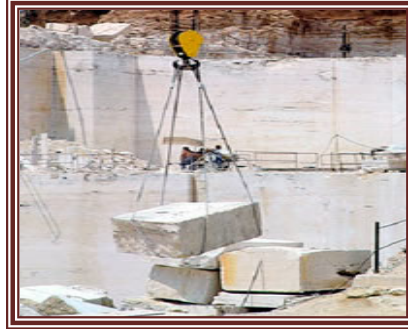
هذه الصور تظهر قطع و استخراج الرخام
