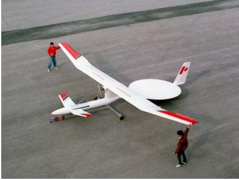
الطائرة بدون طيار الكندية SHARP التي تعمل بشعاع من موجات الميكروويف من الأرض
