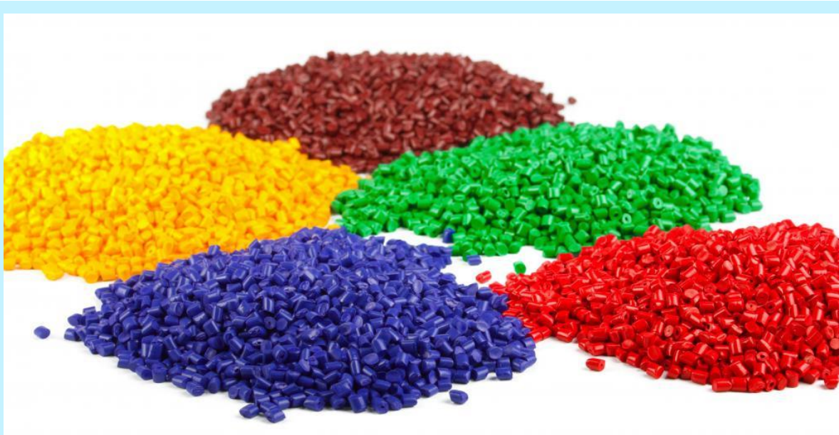
الشكل ( 1.2 ) : عينات من المادة الأولية للبولي برويلين .
