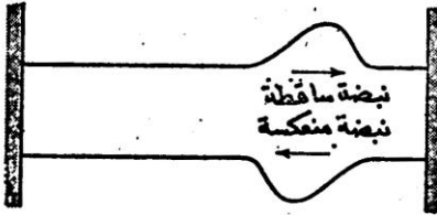
شكل ١٢ - ١٠ اذا كانت النبضة ساقطة على شكل قمة فانها تنعكس على شكل قعر .
