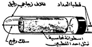
شكل ٧ - ٦ مخطط لتصميم انبوبة عداد كايكر مولر . يمر خلال غلافه الرقيق الدقائق المشحونة فتؤين الغاز الذي بداخله وبذلك يمر تيار .
