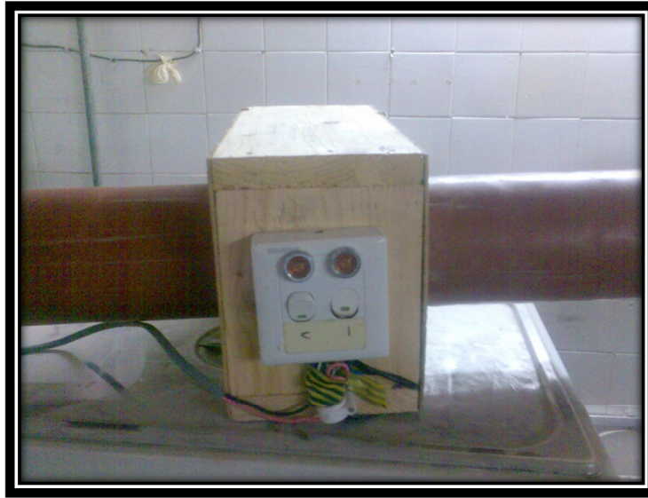
جهاز لانتاج الماء الممغنط من النوع الكهربائي صنع في قسم علوم الاغذية
