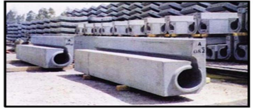
مجارى خرسانية لتصريف مياه الأمطار (نفق الأزهر)
