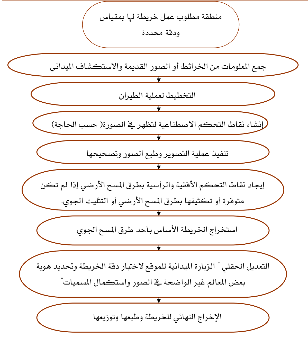
الشكل: ١ - ٥ المراحل الأساسية لإنتاج الخرائط من الصور الجوية
