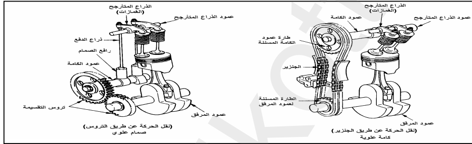
شكل ٢ - ٩ نقل الحركة عن طريق الجزير للكامنة العلوية ونقل الحركة عن طريق التروس
