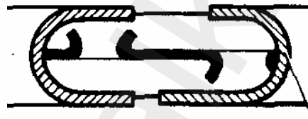
شكل - ٢٨ حشية رأس الاسطوانات من لوح فولاذي غلف سطحه بمادة لينة.
