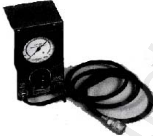
شكل - ١٤ الجهاز قياس تسرب داخل الاسطوانة
