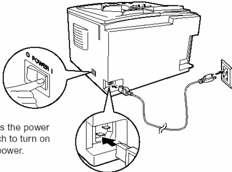
وبعد توصيل الجهاز بالتيار الكهربائي يتم تشغيل الجهاز عن طريق مفتاح التشغيل علماً أن بعض الأجهزة تعمل مباشرة عند ربطها بالتيار الكهربائي.
